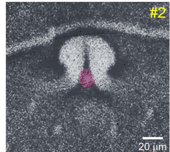
シンクロtronX線トポグラフィーにより捉えた結晶欠陥
